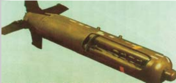
[1] Coupe d'une CBU 87, conteneur de la BLU 97, utilisée par les Forces armées américaines. (Photo: EC, NEDEx)
